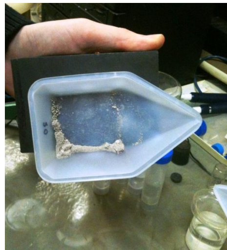
Рис.9. Образцы концентрата золота после отделения мышьяка из арсенопирита.
