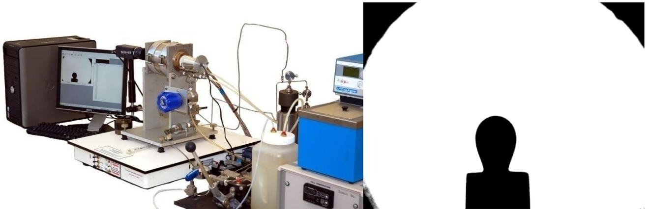
**Рис. 2.2.** Тензиометр IFT-820-P фирмы *Tetco* (США) (а) и изображение формирующейся капли на экране монитора (б).
