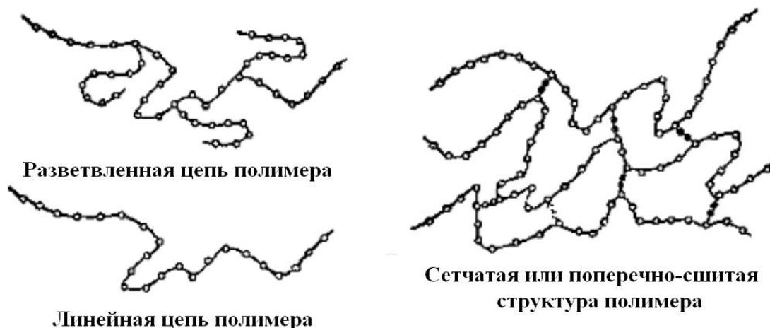
**Рис. 1.9.** Схематичное изображение линейной, разветвленной цепей полимера и поперечно-сшитой структуры полимера [95].
