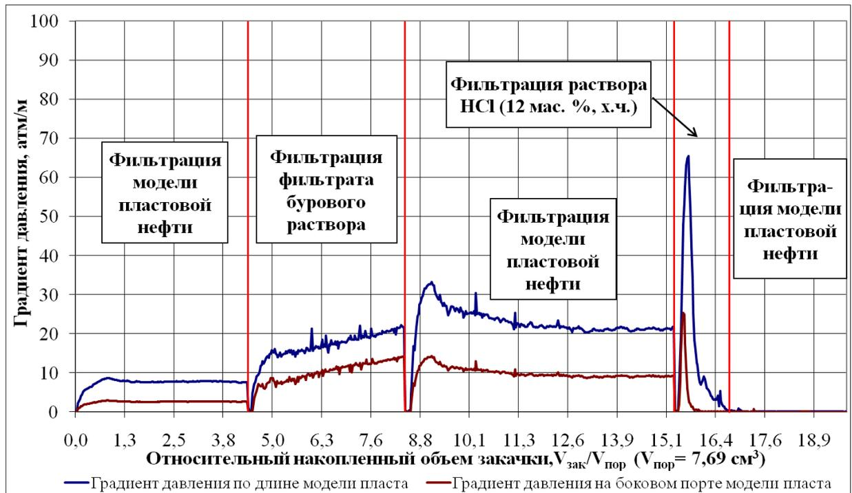
**Рис. 4.1.** Изменение градиента давления по длине и на боковом порте модели пласта при поочередной фильтрации через него флюидов различного химического состава.
