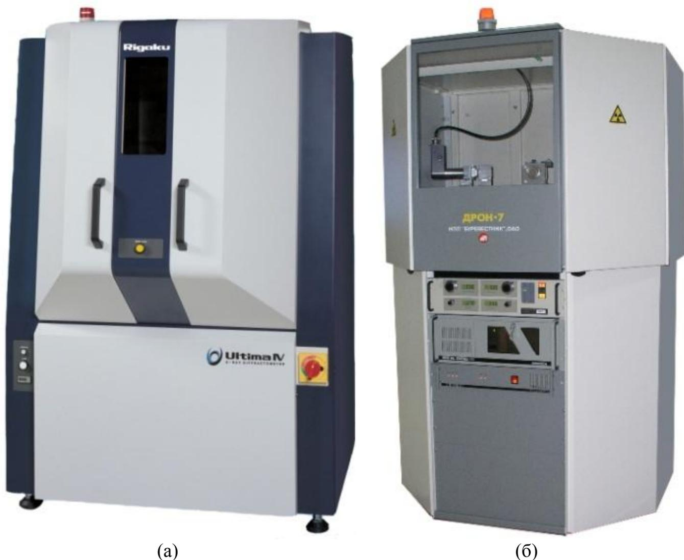
Рис. 2.3. Дифрактометры рентгеновские Rigaku Ultima IV (а) и Дрон-7 (б).
