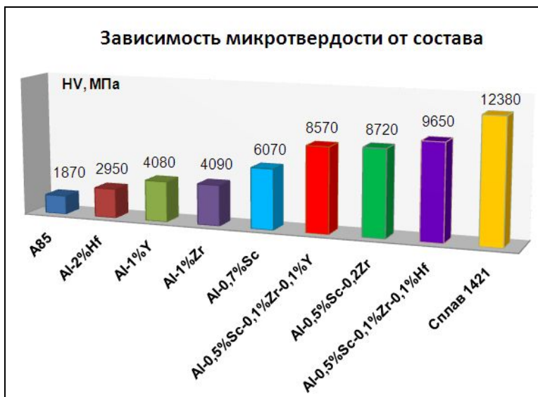
Рисунок 8 – Зависимость микротвердости сплавов от их состава
