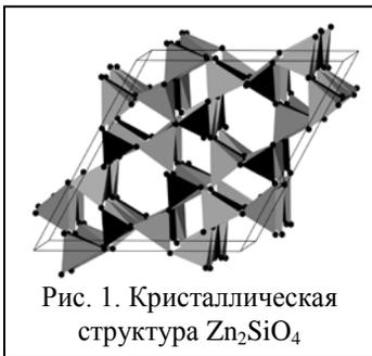
Рис. 1. Кристаллическая структура  $Zn_2SiO_4$
