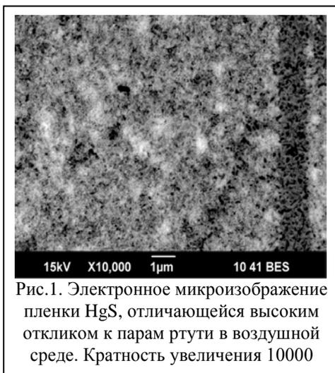
Рис.1. Электронное микроизображение пленки HgS, отличающейся высоким откликом к парам ртути в воздушной среде. Кратность увеличения 10000
