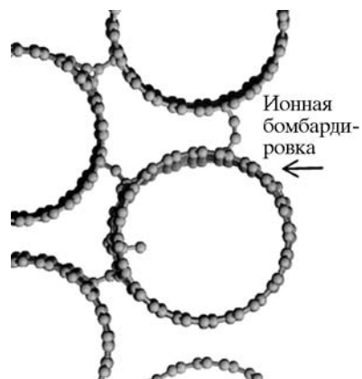
Рис. 4.14. Образование ковалентных С-С-связей между трубками в их пучке при ионной бомбардировке по результатам молекулярно-динамического моделирования [40]
